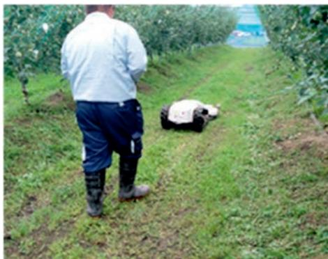
写真2 稼働中のラジコン式草刈機
