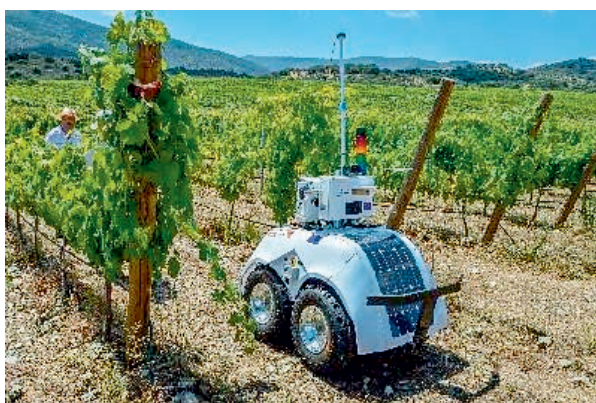
写真 ぶどうのモニタリングロボット VineScout (VineScout Project 提供)
