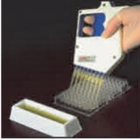
ELISAプレートにウイルス抗体を用意する（上図）。ELISAプレートの色の変化が陽性を示す。
