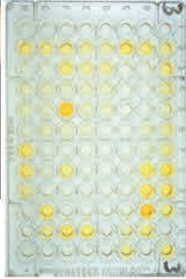
ELISAプレートにウイルス抗体を用意する（上図）。ELISAプレートの色の変化が陽性を示す。
