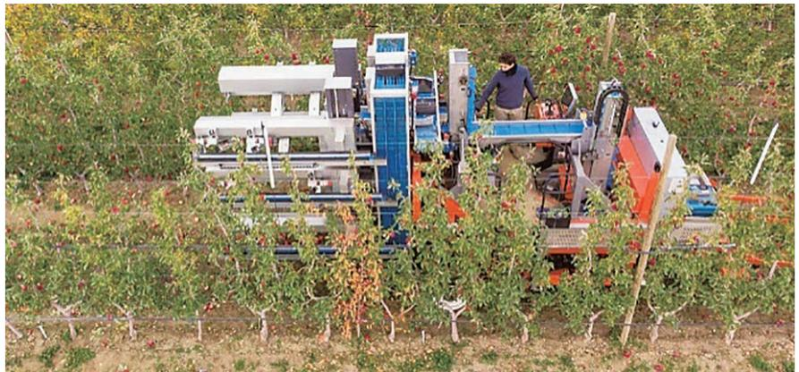
写真：以前より小型化され、ビンへの果実供給システム、ビン移動機構とともに自動水平台車に搭載されたFF Robotics社の収穫機械。技術者が立っているところの上に選果システムを設置可能。
