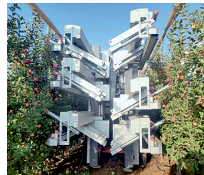
FF Robotics 社の新型収穫ロボット、12のロボットハンドを持ち列間の狭い園地にも対応
