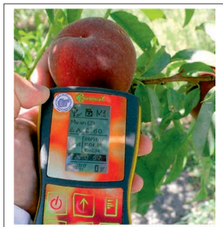
果皮直下のクロロフィル含量を計測し、地色を評価する DA 計。果皮が全体的に赤くなる品種の、熟度を測定するのに便利。
