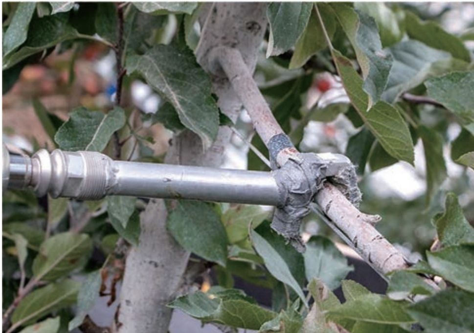
把持部をテープで巻いた振動伝達アームが水平な枝を把持して振動を伝える
