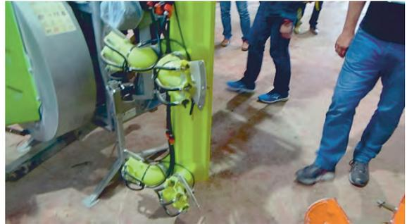
導風型の防除機である。送風機からの送風により、付着性能を高め、かつ、側方からの噴霧によりドリフトを低減できる構造である。この防除機もドリフト低減と付着性能を高めた構造で、日本のSSとは異なる構造である。構造の大きく異なる防除機を4台保有していることから生産者の高いドリフト低減への意識が感じられた。
