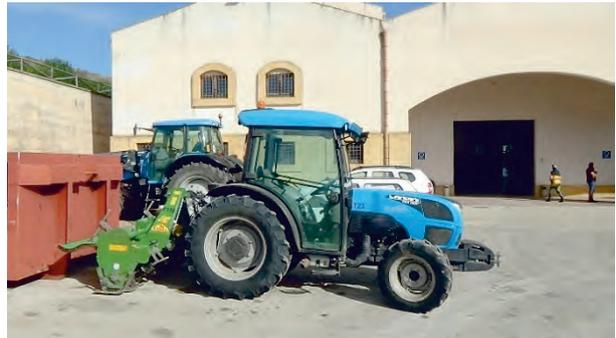
通路の草生を管理するためのトラクタ装着型中耕播種機である。
