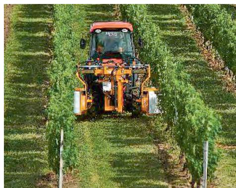
図 30 ぶどうのせん定機械 (左) と摘葉機械 (右) の例
