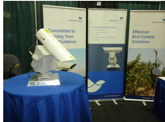
レーザー利用の防鳥システム
