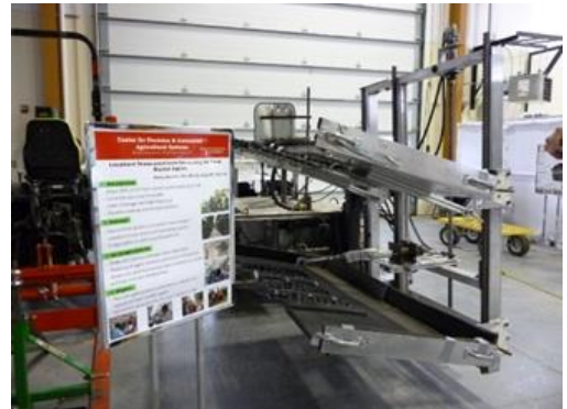
りんご振動収穫機械のプロトタイプ
