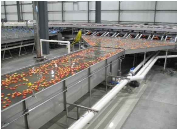
障害のない果実は再び水槽の中を移動
