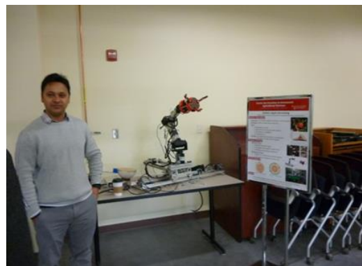
りんご収穫ロボットのプロトタイプ
