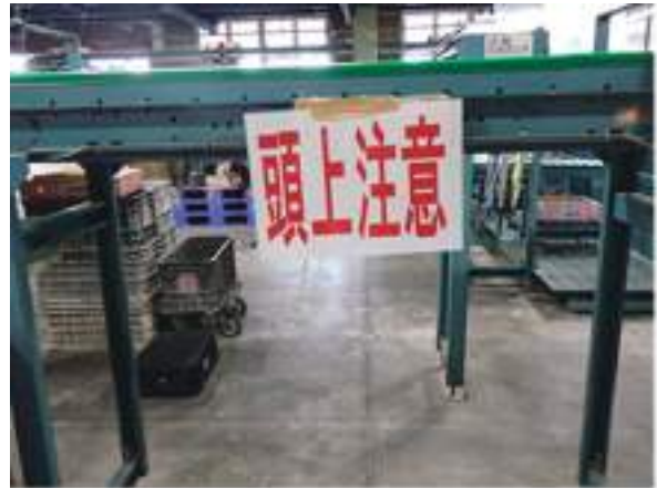
「頭上注意」の掲示による安全管理
