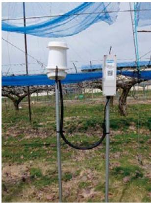
写真7 気象モニタリングシステム(センサー部)
