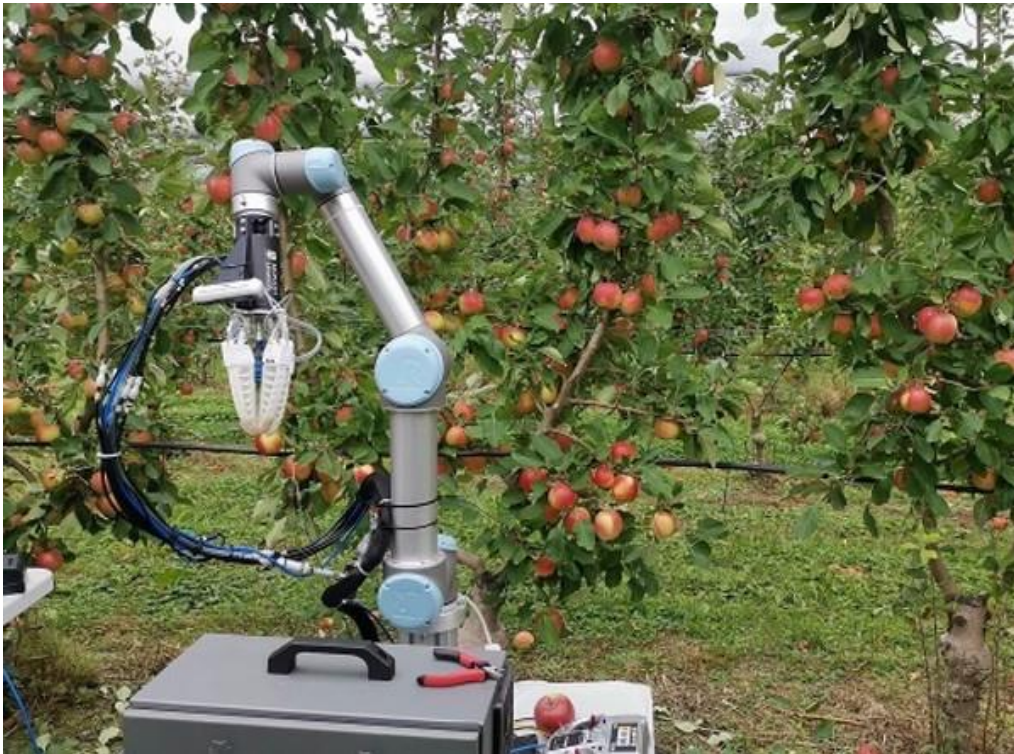
モナシュ大学の研究者らによって制作されたリンゴ収穫ロボットのほ場での運転速度試験
