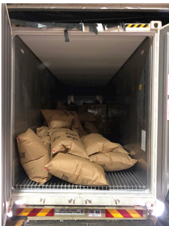
容積増量用のダミー (エアバッグ)
