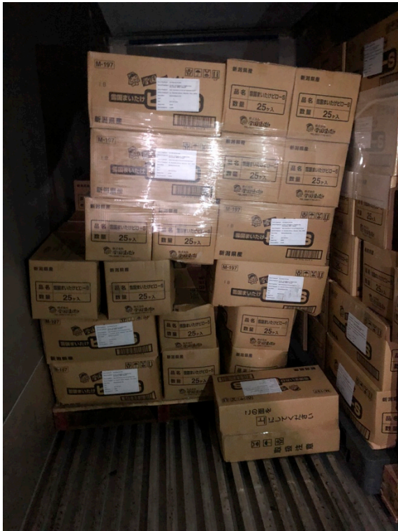
庫内奥の貨物のうちラップがけの弱い 箇所から荷崩れを起こしている。
