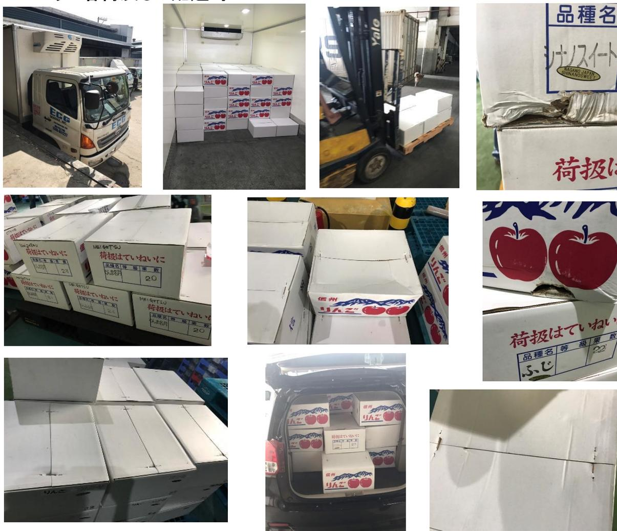
耐水性段ボールは、潰れ・へこみ等 外装損傷がない。
