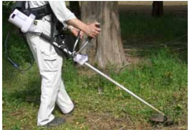
写真2 軽量・低騒音・低振動のモーター 駆動式刈払機を用いた除草作業
