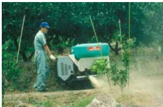
写真1 自走式肥料散布機を用いた 機械施肥（近中四農研）
